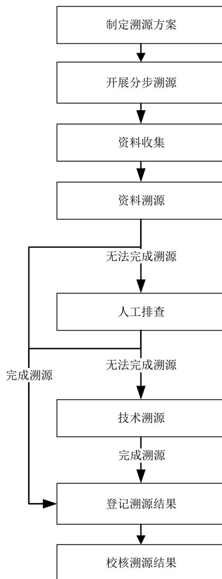
图 1 入河排污口溯源工作流程
